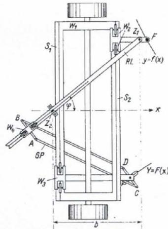
Abb. 6: Schematische Darstellung des Integraphen (Willers, 1942)
