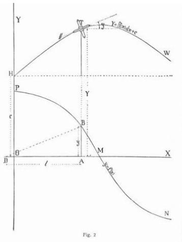
Abb. 5: Graphisches Integrieren und Prinzip eines Integraphen (Lossier, 1911)
