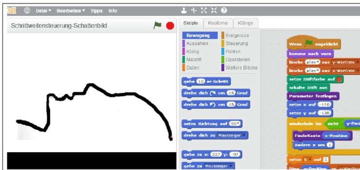
Abb. 4: Erfassung des Schattenbildes eines Schülers mithilfe einer in Scratch programmierten Schrittweitensteuerung
