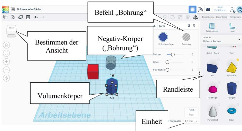
Abb. 2: Programmoberfläche von Tinkercad™.
