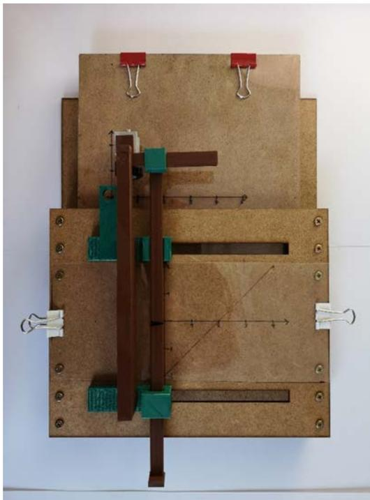
Abb. 4: Mit 3D-Druck-Technologie entwickelter Integraph
