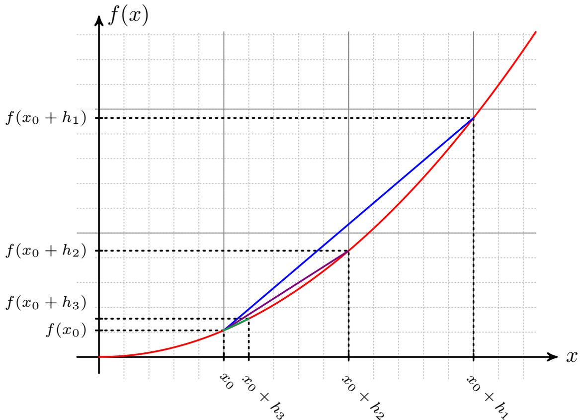
**Abbildung 20:** Annäherung an die Tangente durch die  $h$ -Methode
