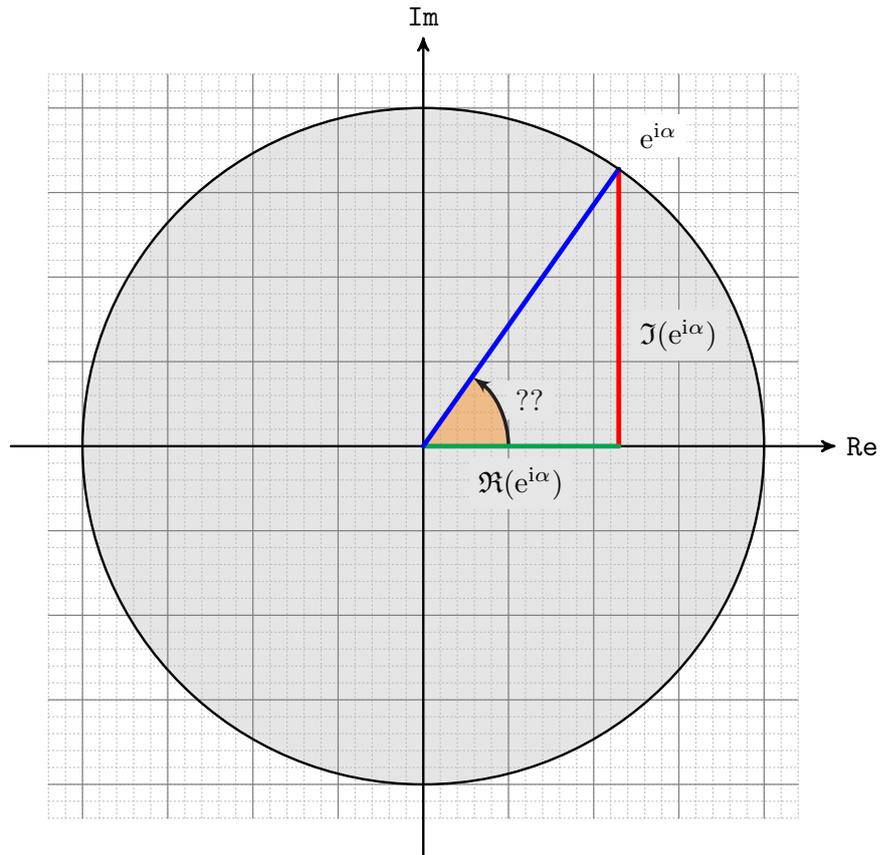
Abbildung 18: Komplexer Einheitskreis – Real-, Imaginärteil und Winkel
