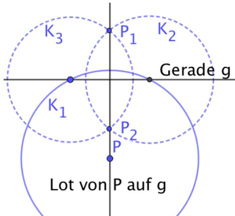
Die Schnittpunkte des Kreises  $K_1$  um  $P$  mit  $g$  liegen gleich weit auf  $g$  beiderseits des Lotfußpunktes. Gleich große Kreise  $K_2, K_3$  um diese Punkte schneiden sich auf dem Lot.
